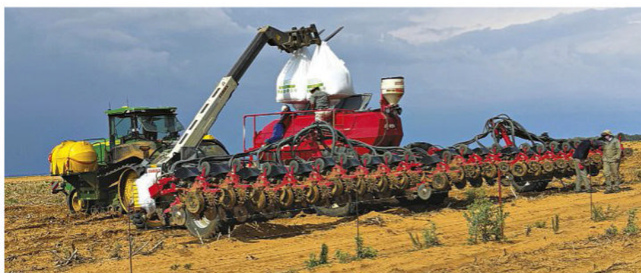
Kunsmis word met 'n Claas Telehandler in 'n Horsch 24-ryplanter gelaai. Die trekker is 'n John Deere 9570.
