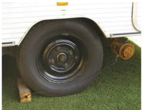
DIE WIELE DRAAI. Met sy onafhanklike vering was die 1981 Sprite Sport so modern as wat dit kan wees (foto bo). 'n Tuisgemaakte wielotjok is net die antwoord om alleen teen 'n skuinste reg te kom (foto onder).
